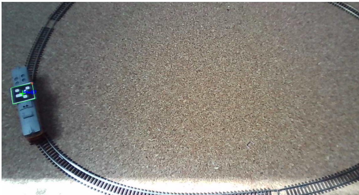
Obrázek 4.3: Výstup modulu počítačového vidění: identifikovaný ArUco marker s vyznačeným středovým bodem a hranami.
