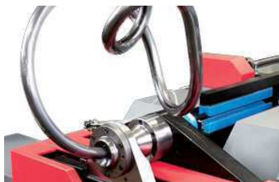
Obr. 2.17 Zařízení při ohybu trubky [17]
