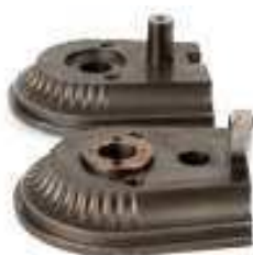
Obr. 5.5 Tvarovaná matrice [43] Obr. 5.6 Součást vyrobená pomocí tvarované matrice [18]
