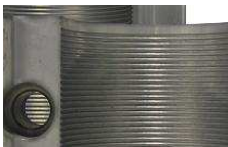
Obr. 5.3 Úprava drážky rýhováním. [18] Obr. 5.4 Vyměnitelná upínací část matrice [18]
