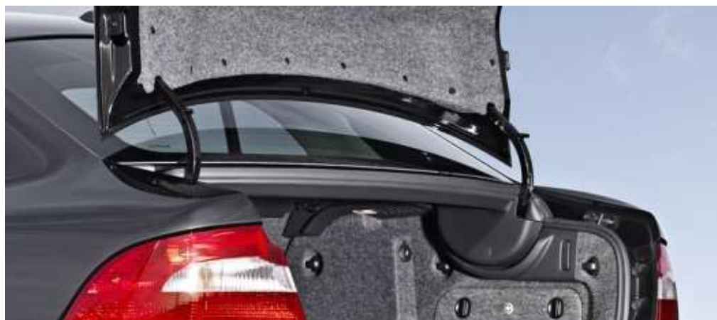
Obr. 7.2 Detail na závěs dveří systému TwinDoor [39]
