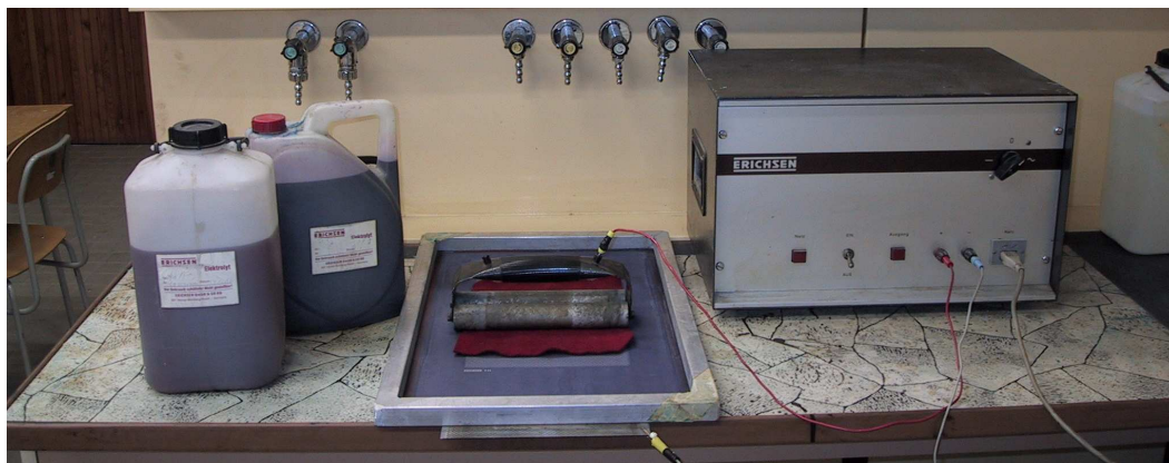
Obr. 8.2 Pracoviště elektrolytického nanášení sítě [40]
