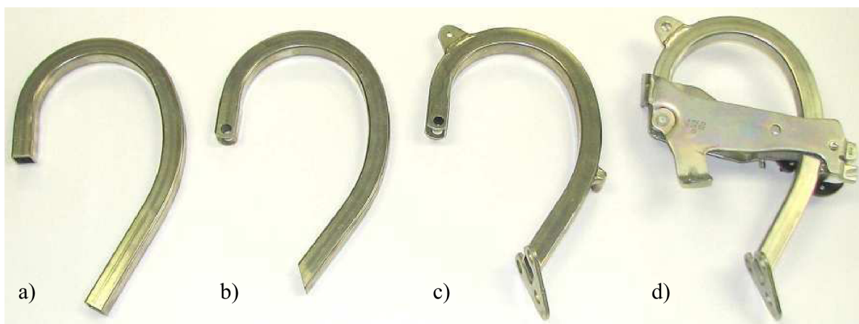
Obr. 7.3 Postup výroby závěsu pátých dveří [31]
