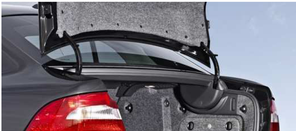
Obr. 7.2 Detail na závěs dveří systému TwinDoor [39]
