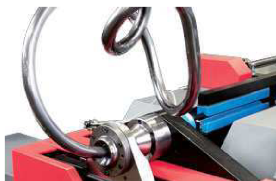
Obr. 2.17 Zařízení při ohybu trubky [17]
