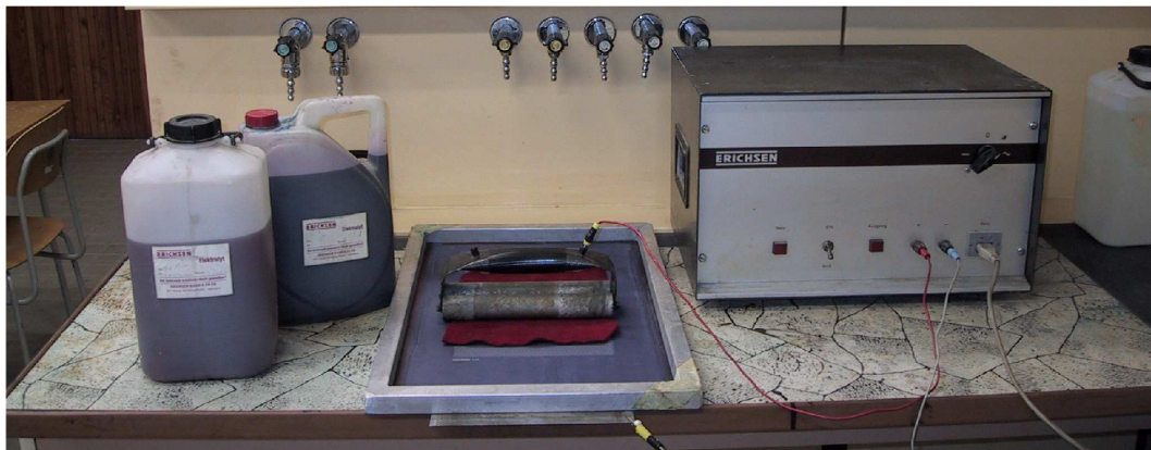
Obr. 8.2 Pracoviště elektrolytického nanášení sítě [40]
