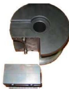
Obr. 5.3 Úprava drážky rýhováním. [18] Obr. 5.4 Vyměnitelná upínací část matrice [18]
