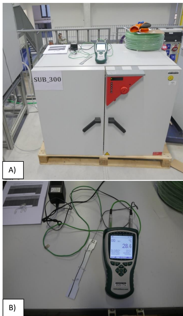
Obr.9) A) teplotní komora použitá k simulaci vytvrzovacích procesů lakovny B) Uchytení termočlánku na povrchu jednoho z testovaných vzorků
