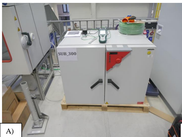
Obr. 4. A) Uložení plechů v sušící peci při simulaci KTL; B) Rozložení vzorku na roštu
