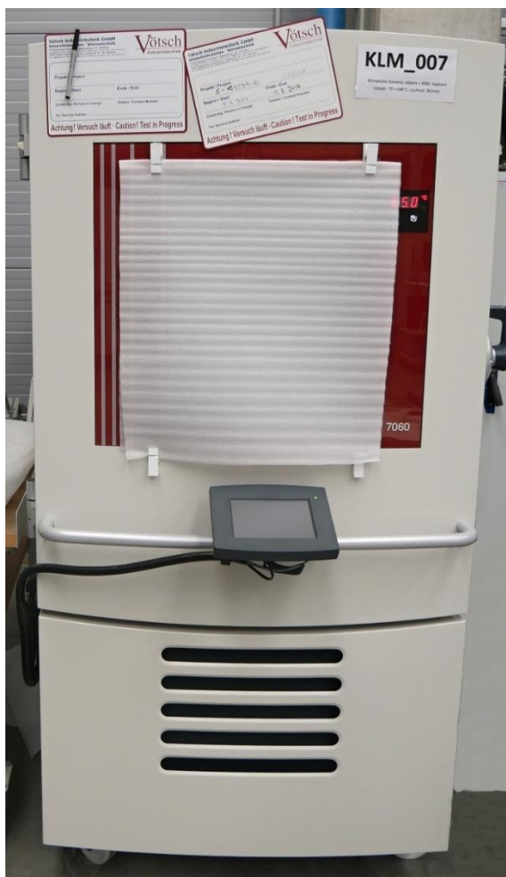
Obr. 3. Uložení zkušebních vzorků před tepelnou úpravou KTL při 5°C
