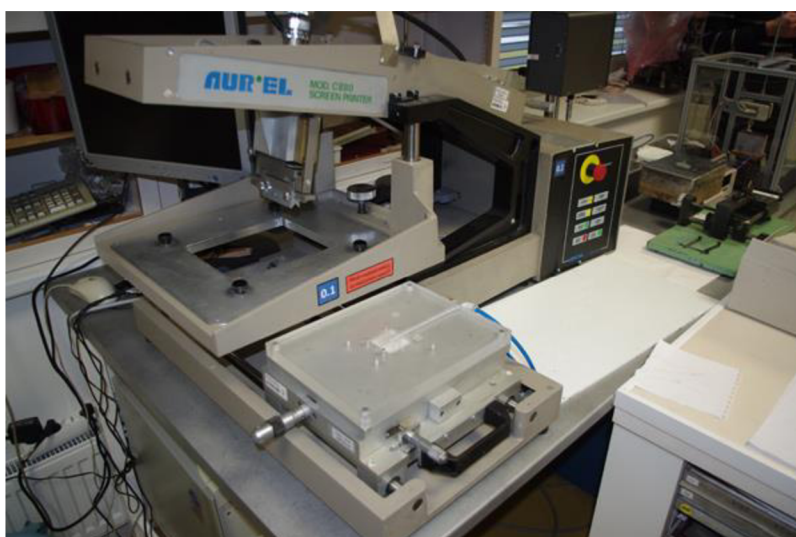
Obr. 26 Sítotiskový poloautomat AUREL mod. C880 [19]
