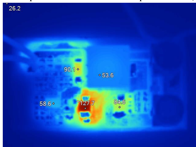
Obr. 5.11 Teplota tranzistorov pri plnom zaťažení meniča: dolný spínač - 127,7 °C, horný spínač - 84,6 °C, cievka 53,6 °C, IO 58,6 °C, bočnik 90,1 °C a teplota okolia 26,2 °C
