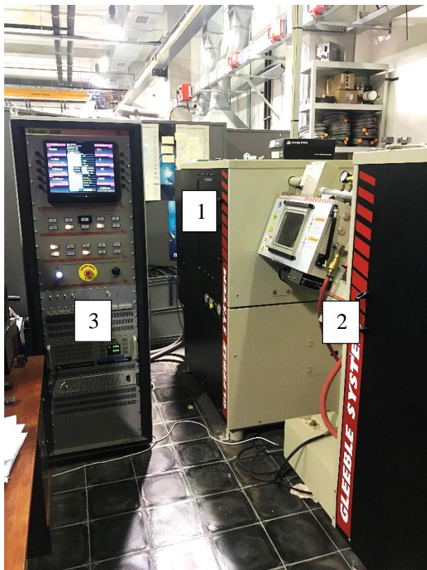
Obr. 2.4.1 Hlavní části systému Gleeble, hlavní jednotka (1), testovací zařízení (2), ovládací panel (3)
