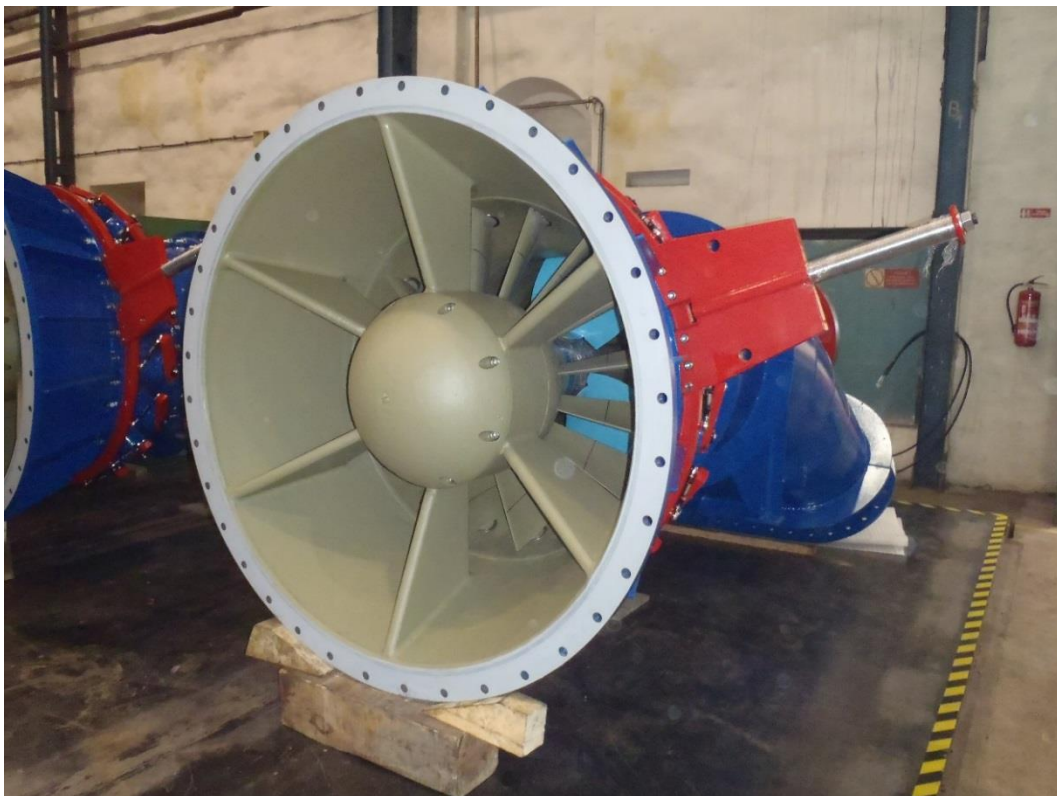
Obrázek 18: Pohled do Kaplanovy turbíny MVE Počáply
