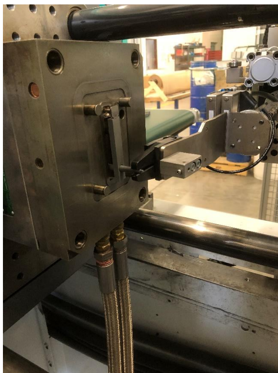
Obrázek 25: Lisování rázového tělíska
