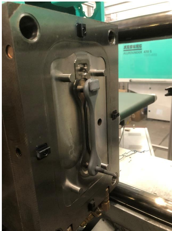
Obrázek 26: Lisování tahového tělíska.
