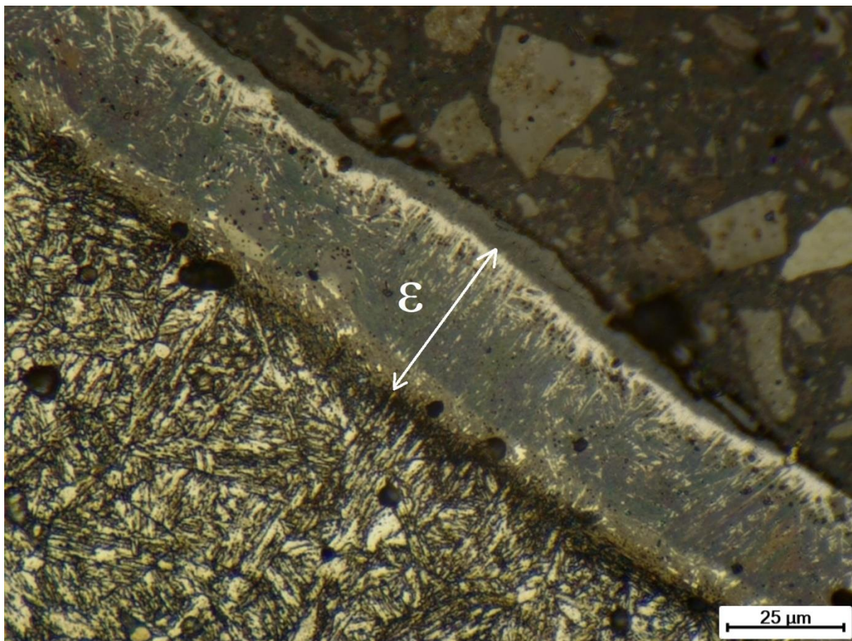
Obrázek 40: Analýza struktury vrstvy pomocí optického mikroskopu - vzorek 4 (SIN – VYT – ARCOR).
