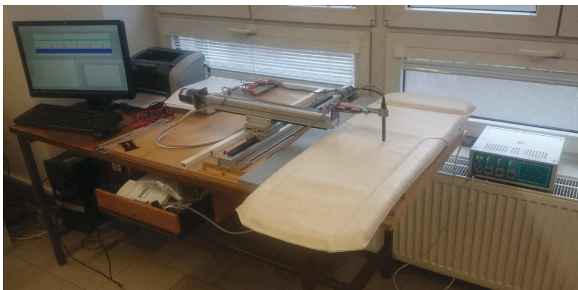
Obrázek 2.14 Měření lůžkové podložky pantografem
