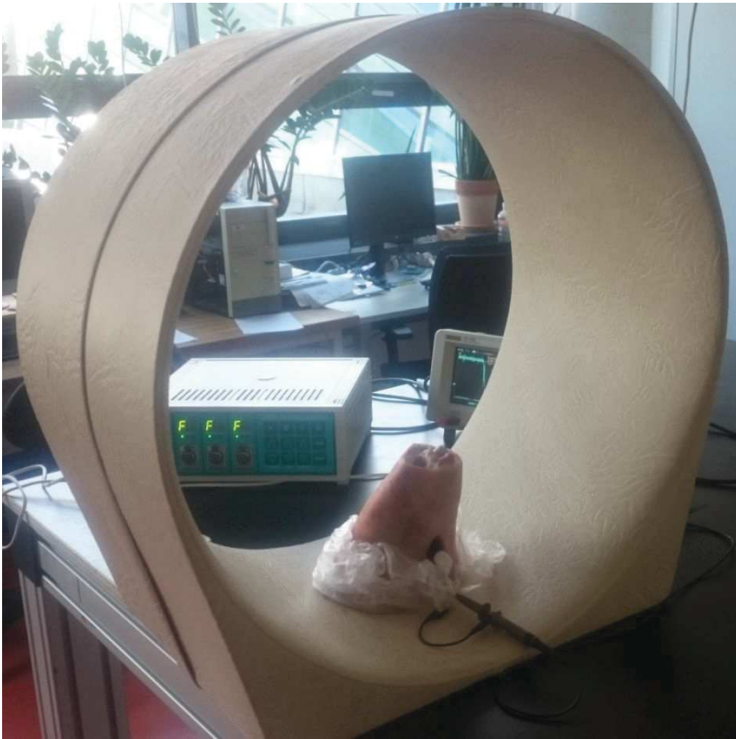
Obrázek 2.18 Měření průběhu napětí cívky s vepřovým kolenem umístěným v solenoidním aplikátoru
