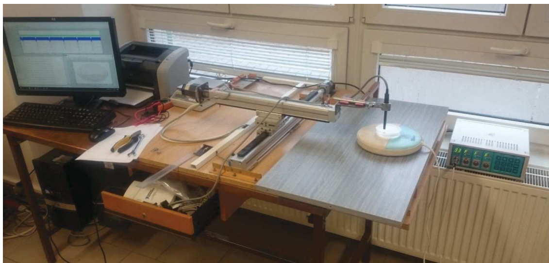
Obr. 2.10 Měření kruhového aplikátoru s fantomem na pantografickém přístroji
