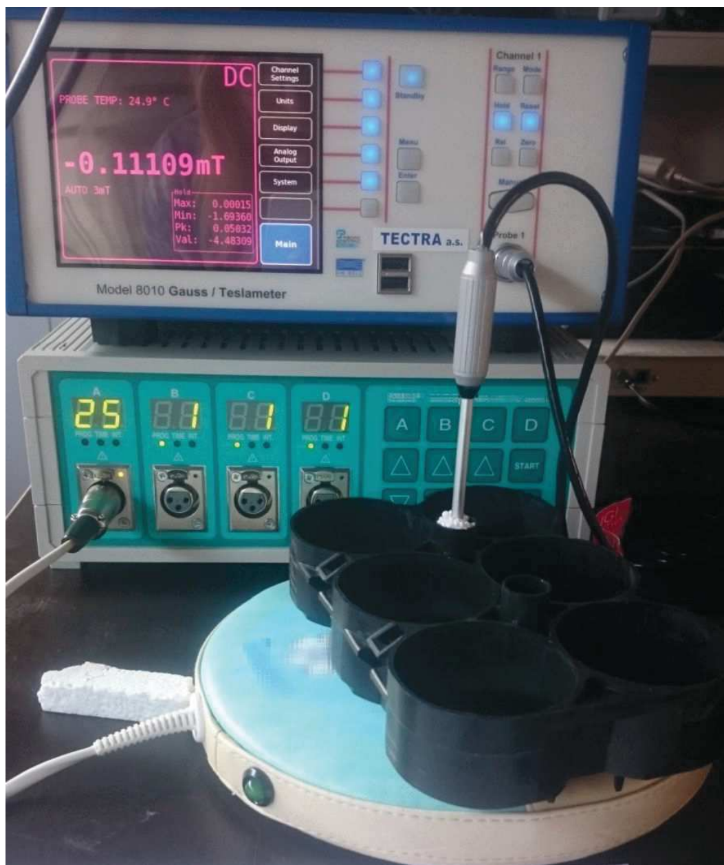
Obrázek 2.8 Měření kruhové podložky Hallovoú sondou (zdroj: autor – upraveno)
