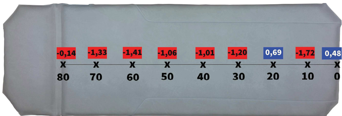
Obrázek 2.23 Lůžkový aplikátor – naměřené B [mT] (zdroj: autor – upraveno)
