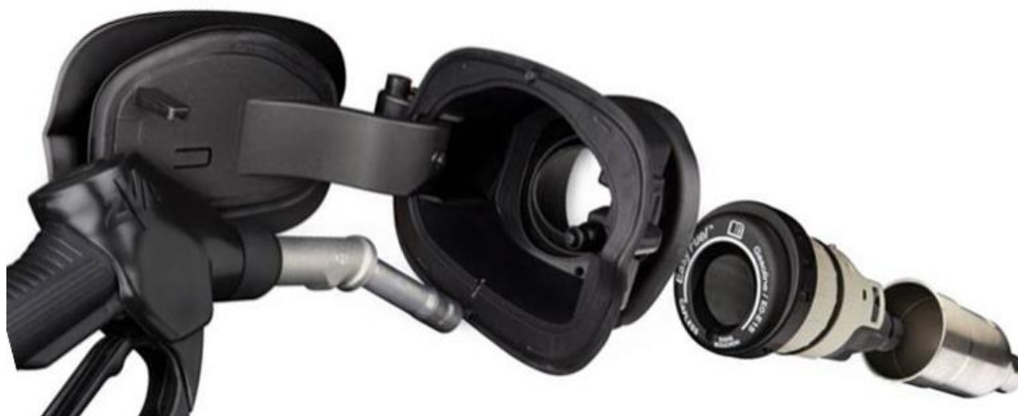
Obr 4) Palivový systém s bezvíčkovým uzavíráním nádrže [17]
