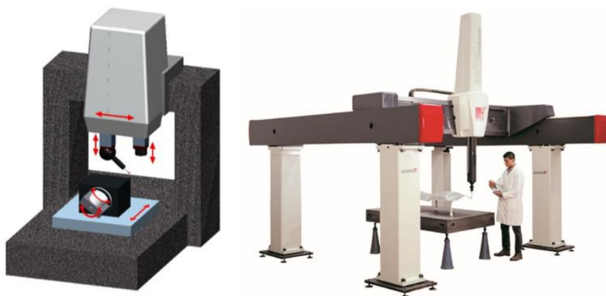
Obr 18) Mostová konstrukce SMS a) schéma a b) ukázka ALWAID MCT SL [14], [32]
