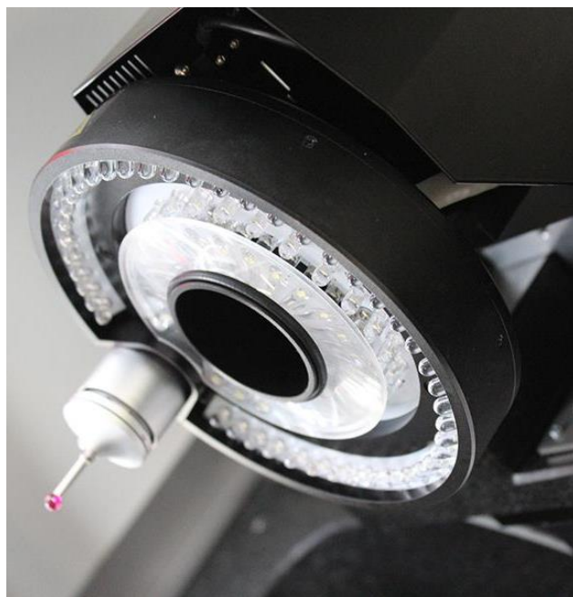
Obr 34) Optiv performance 443 a) stroj a b) dotykový snímač a optický senzor [11]
