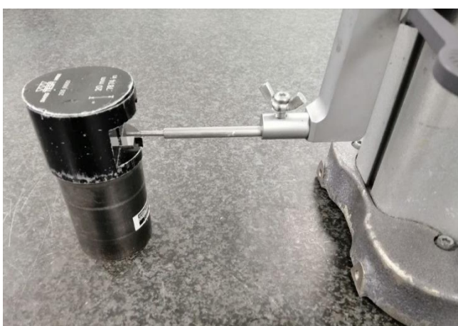
Obr 29) a) výškoměr TESA Hite 700, b) měřící doteky výškoměru, c) kalibrace měřícího doteku [34]
