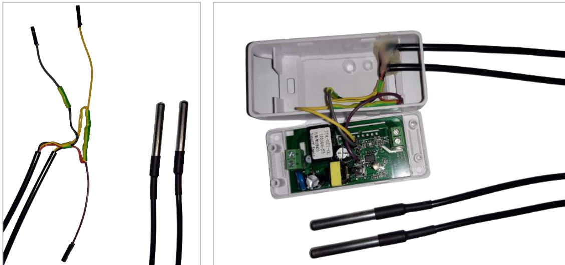
Obrázek 22: Příprava a zapojení dvou teplotních senzorů k modulu
