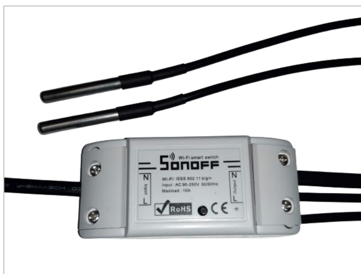
Obrázek 23: Výsledný modul obsahující dva teplotní senzory
