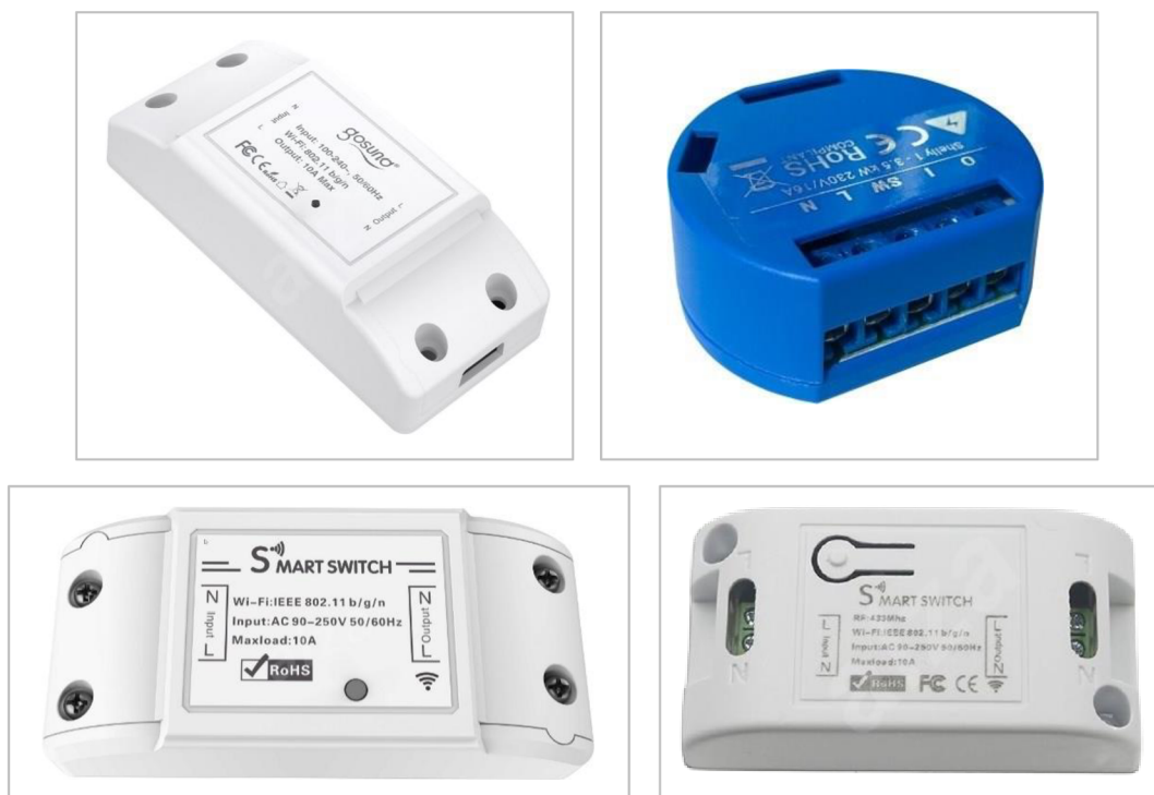
Obrázek 2: Moduly značek Gosund [9], Shelly [12], Woox [10] a iQtech [13]
