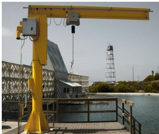
Obr. 4 Sloupový jeřáb s vodorovným výložníkem [19]
