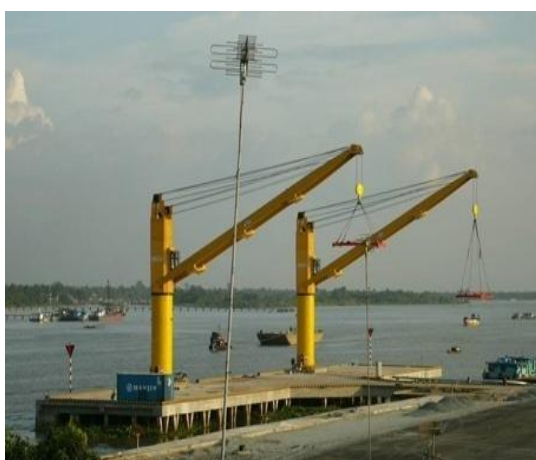
Obr. 3 Jeřáb se sklápěcím výložníkem [20]
