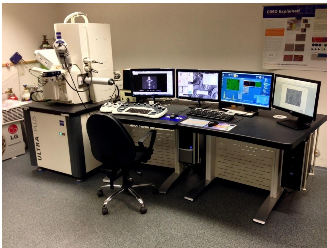
Obr. 11: Rastrovací elektronový mikroskop (SEM) Carl Zeiss ULTRA Plus – Laboratoř analytických metod Ústavu pro nanomateriály TUL
