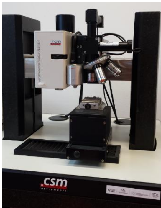
Obr. 13: Přístroj pro měření gradientu tvrdosti – CMS Instruments Indentation tester s nanotvrdoměrem NHTX S/N: 01-03880.
