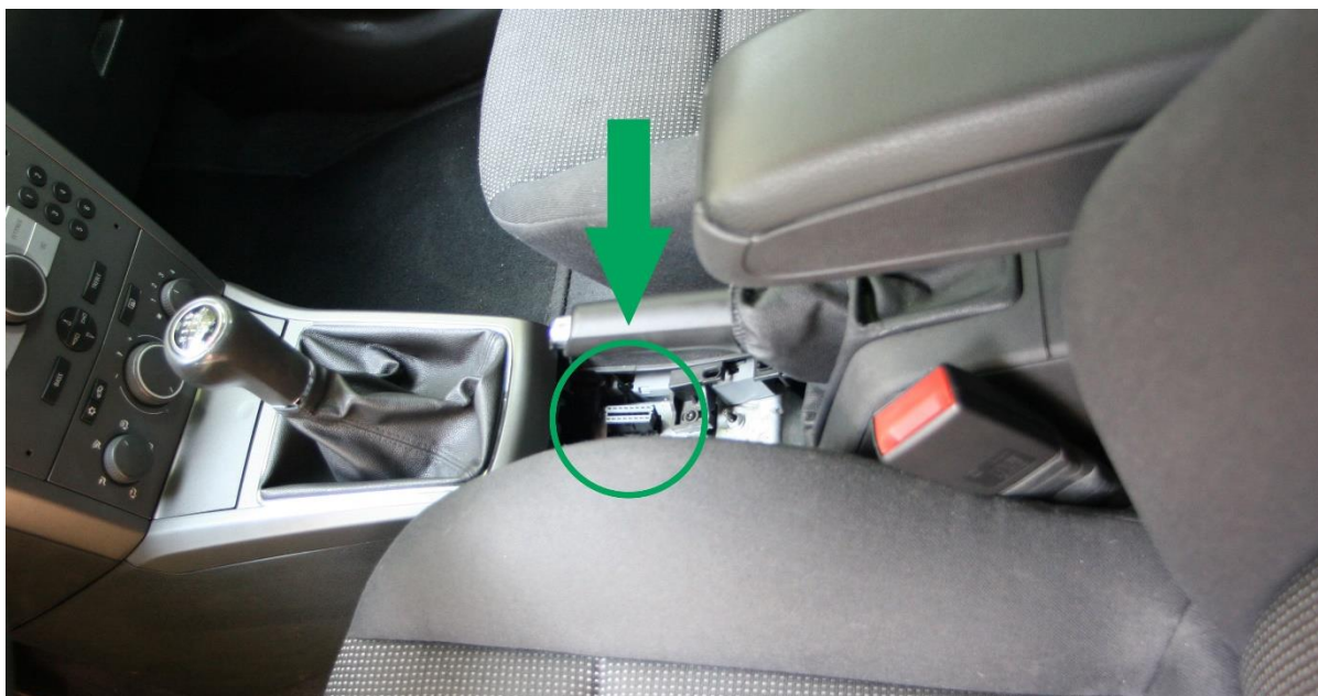
Obrázek 6.2: Umístění diagnostického konektoru ve vozidle Opel Astra H Gtc ve středovém tunelu pod pákou ruční brzdy.
