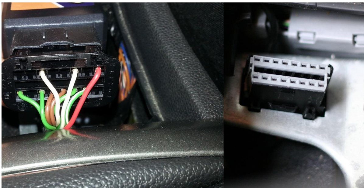
Obrázek 6.12: Zapojení diagnostického konektoru v testovaném vozidlu.
