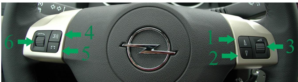
Obrázek 6.13: Ovládací tlačítka rádia (vpravo) a palubního počítače (vlevo) na volantu testovaného automobilu.
