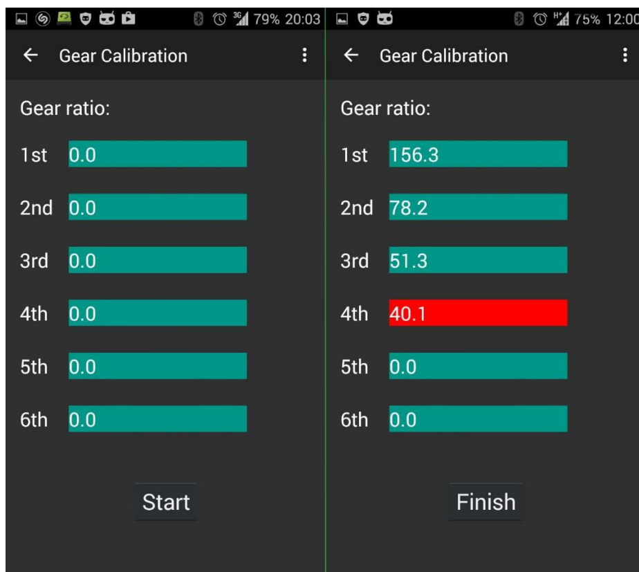
Obrázek 6.11: Obrazovka kalibrace převodových stupňů (Gear Calibration). Vlevo před začatím a vpravo v průběhu probíhajícího procesu kalibrace s aktuálně zařazeným čtvrtým převodovým stupněm (zvýrazněn červenou barvou).
