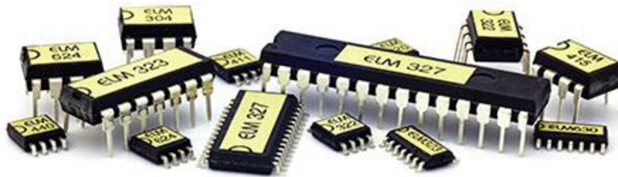
Obrázek 6.4: Originální verze mikrokontroléru ELM327 disponuje podle stránek výrobce velkým nápisem ELM327 na "zádech" pouzdra mikrokontroléru 13 .
