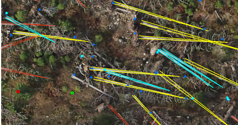
Obr. č.12 detail zkušné plochy, modré linie - nejvíce chybové kmeny, modré kruhové body – poloha vrcholů dle GNSS měření
