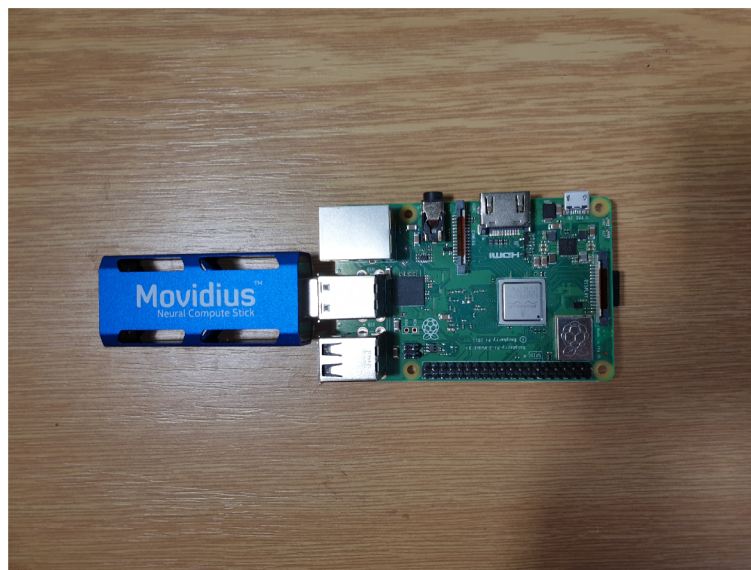
Obr. 3.3: Raspberry Pi 3 Model B+ s pripojeným akcelerátorom Intel Movidius.
