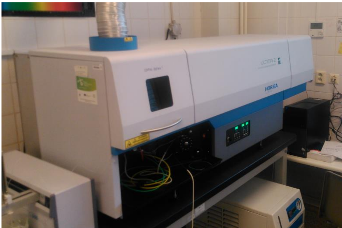
Obr. 31: Optický emisní spektrometr ULTIMA 2 HORIBA Scientific.
