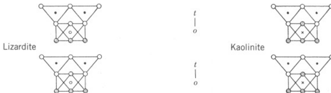
Obr. 10: Znárodnění spojení tetraedrické a oktaedrické sítě minerálů skupiny serpentinu – kaolinitu (trioctaedrická síť nalevo a dioctaedrická síť napravo). [10]
