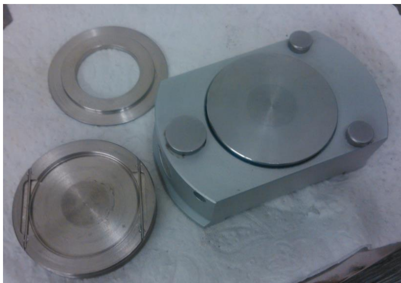
Obr. 34: Tabletovací forma pro metodu XRD.
