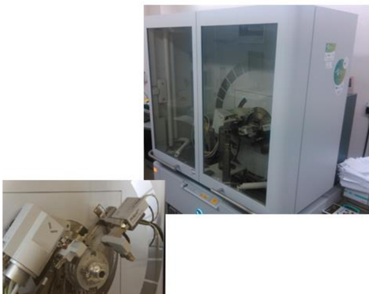
Obr. 35: Rentgenový difraktometr EMPYREA.
