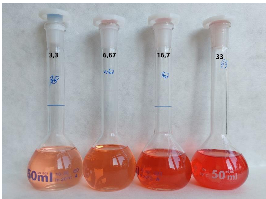
Obrázek 12: Kalibrační roztoky TPF v rozmezí koncentrací 3,3–33 \mu\text{g}\cdot\text{ml}^{-1} (foto bylo pořízeno po ukončení měření z důvodu nestability roztoků na světle)
