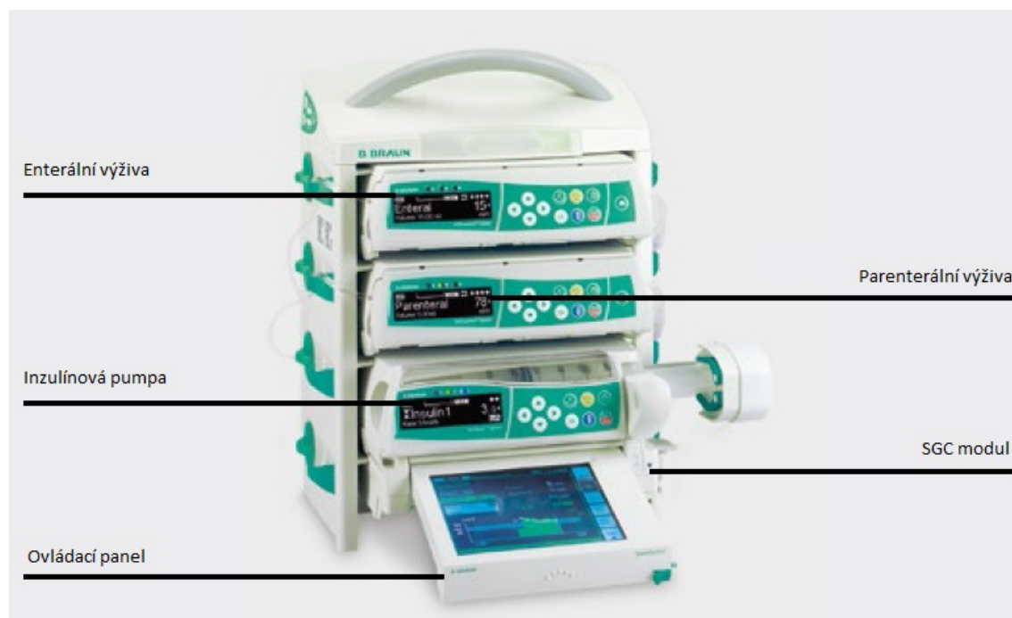
Obr. 4.1: SGC systém s parenterální a enterální výživou, inzulínovou pumpou, SGC modulem a ovládacím panelem, [5].
