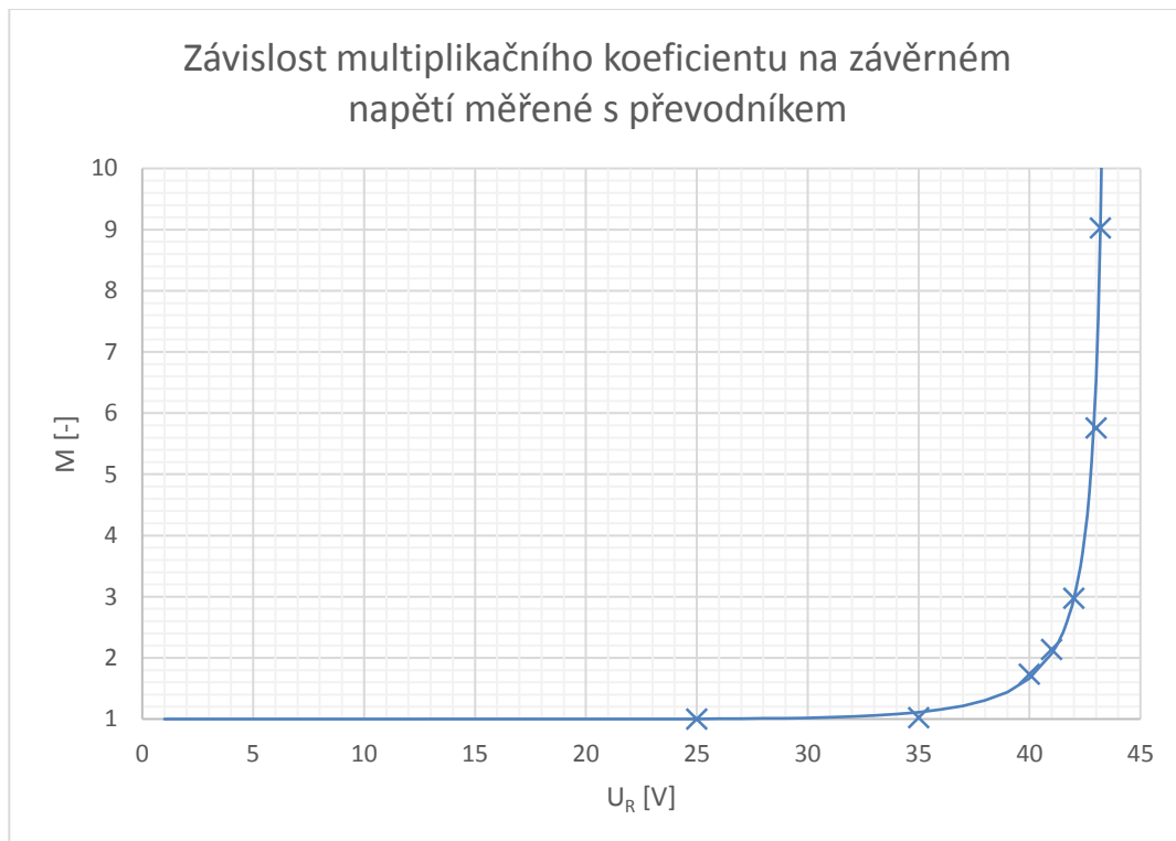
Obr. 5-8: Závislost multiplikačního koeficientu na závěrném napětí měřené s převodníkem
