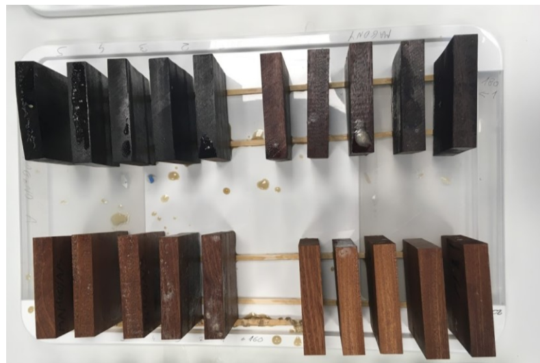
Obr. 17 Aplikace přírodního retardéru hoření na dřevinu mahagon
