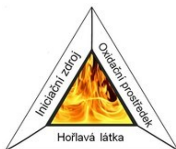
Obr. 9 Trojúhelník hoření (Uhrová, 2013)
