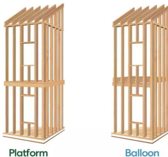
Obrázek 4 - Schéma sloupkových dřevostaveb 70
