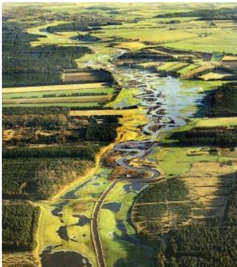
Obr. 7: Pohled na dánskou řeku Brede ke konci 20. Století. Přímá trasa koryta přechází v meandrující, kdy se zvětšený průtok částečně rozlévá do nivy. Zdroj: Revitalizace v zahraničí a u nás, 2014
