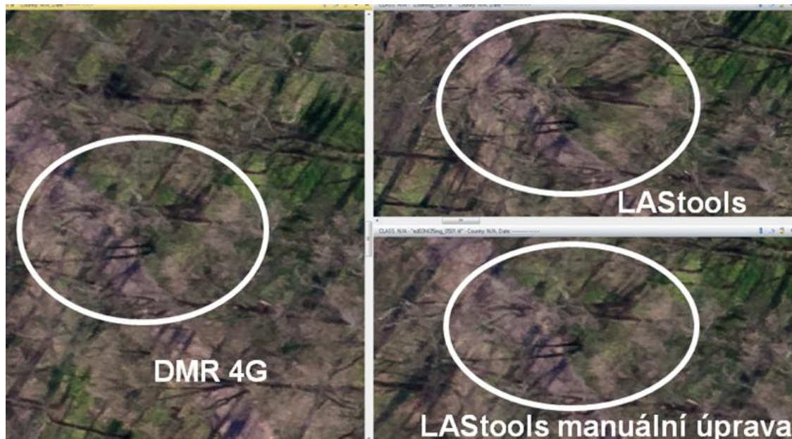
Obr. 25 Ukázka nutnosti drobné manuální editace mračna bodů a její vliv na vizuální přesnost ortofotosnímku (autor: R. Minařík, 2015).
