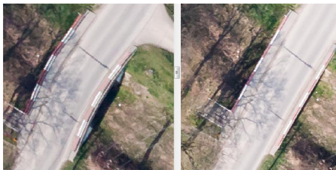
Obr. 24 Most ve Střeni zachycený na okraji snímku č. 503 (vlevo) a v centru snímku č. 501 (vpravo). Snímky jsou ortogonalizovány podle DMR4G (autor: R. Minařík, 2015).
