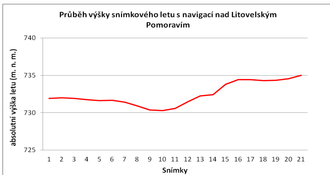
Obr. 15 Graf průběhu výšky snímkového letu s navigací (autor: R. Minařík, 2015).
