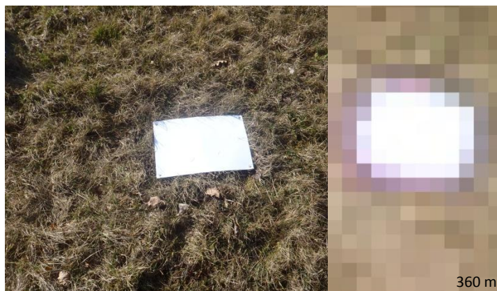
Obr. 10 Vlastní řešení stabilizace dočasného vlíčovacího bodu (vlevo) a jeho obraz na snímku při maximálním zvětšení (autor: R. Minařík, 2014).
