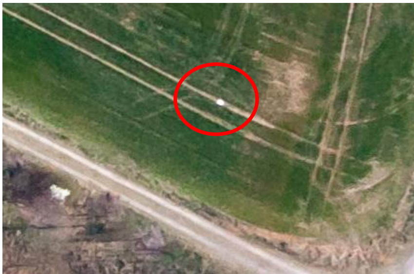
Obr. 11 Vlíčovací bod signalizovaný bílým papírem na snímku z výšky 360 m (autor: R. Minařík, 2015).
