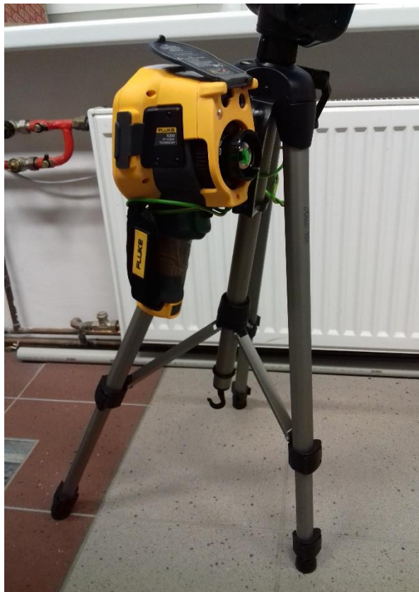
Obrázek 49: Současné měření teploty termokamerou a teplotními čidly
