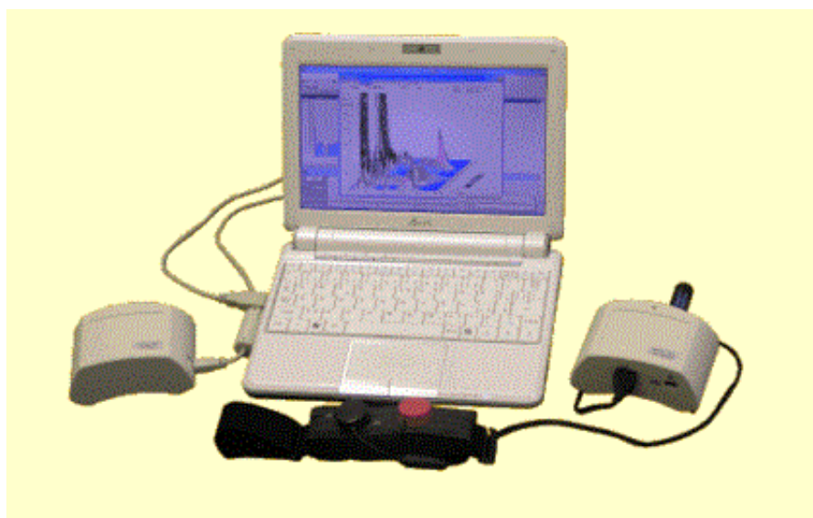
Obrázek 4. Mikropočítačový diagnostický systém VarCor PF 7 skládající se z hrudního pásu s elektrodami, vysíláče a přijímačekódovaného radiového signálu Retrieved 25. 4. 2016 from the World Wide Web: http://dawhois.com/site/dimeagroup.com.html
