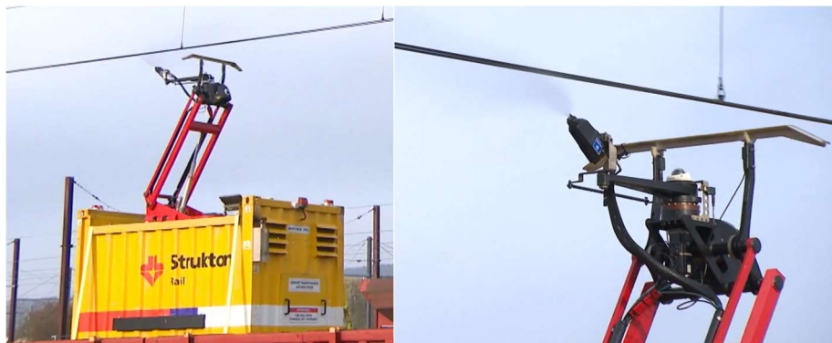
Obr. 3-15 Vlevo celý systém IceGuard , vpravo jeho nanášecí hlava. [59]
