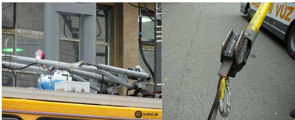
Obr. 3-9 Vlevo umístění systému ČARK [38], vpravo botka sběrače pro nanášení kapaliny. [39]
