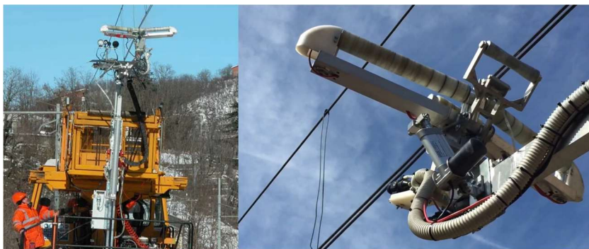
Obr. 3-14 Vlevo celý systém FroSTOP [56], vpravo jeho nanášecí hlava. [57]
