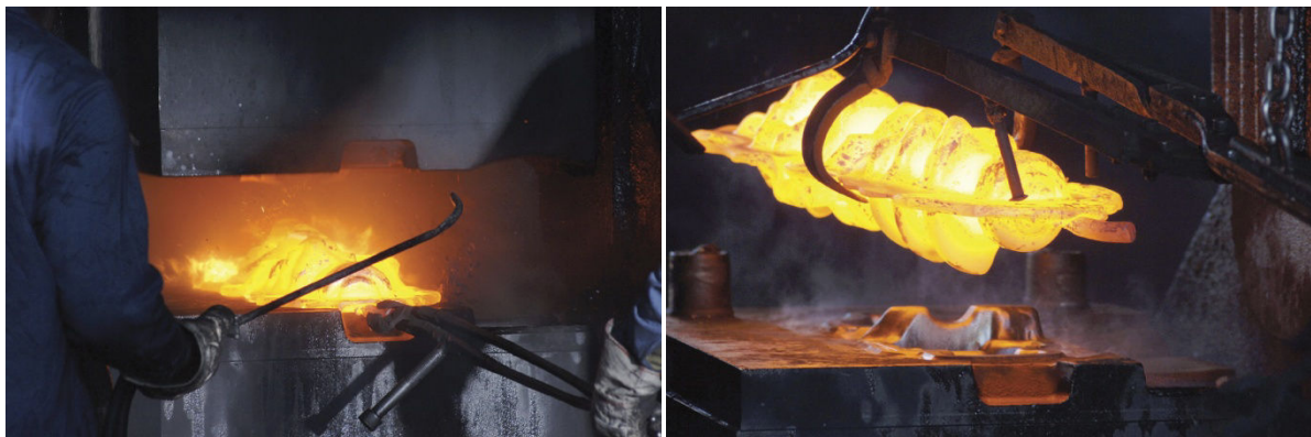
Obr. 16 Výsledný tvar výkovku s výronkem (vpravo) [18]
