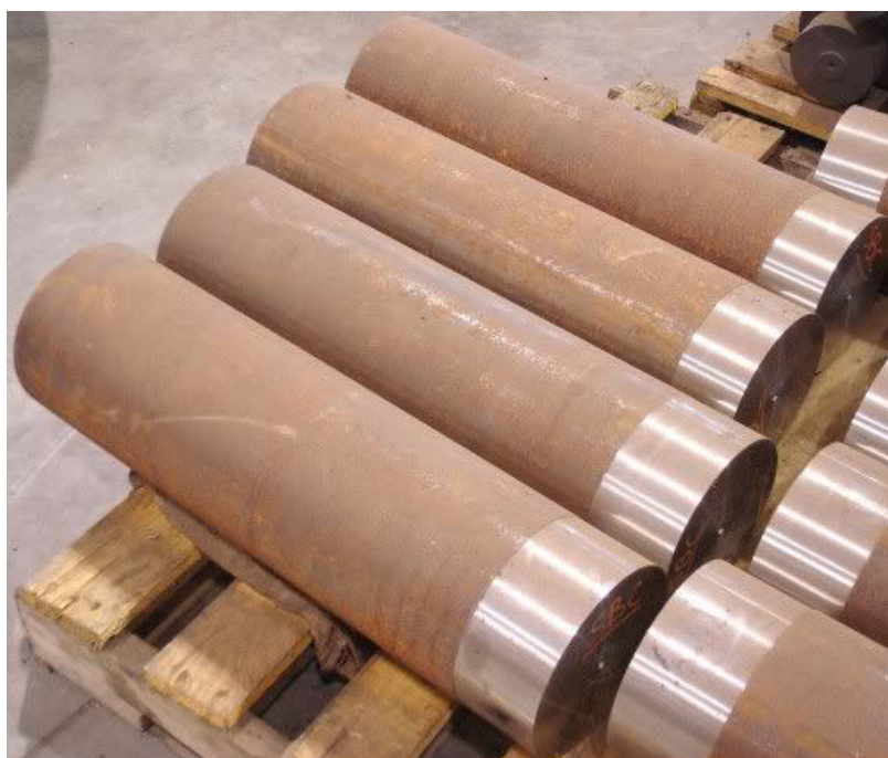
Obr. 17 Polotovar pro výrobu celobráběných klikových hřídelí [18]
