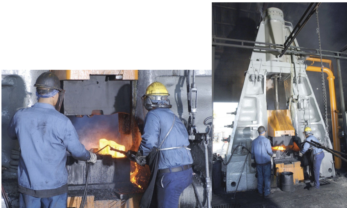
Obr. 15 Vkládání žhavého polotovaru do zápustky a ukázka přetvářecího stroje (buchar) [18]
