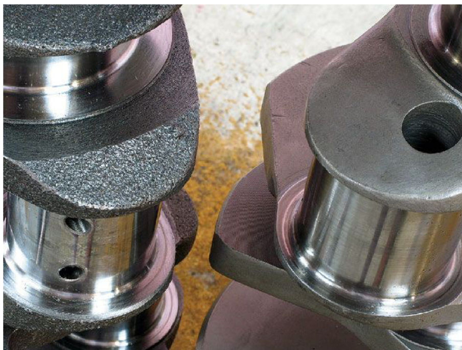
Obr. 14 Porovnání odlévané (vlevo) a kované (vpravo) klikové hřídele [18]
