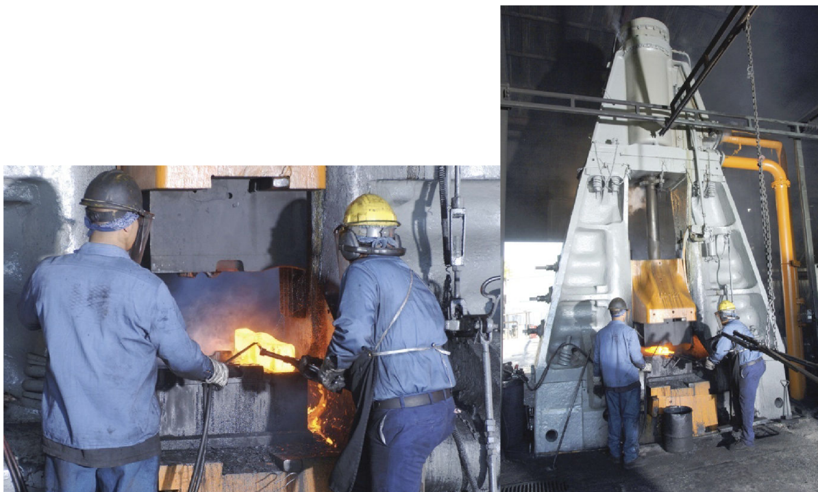
Obr. 15 Vkládání žhavého polotovaru do zápusťky a ukázka přetvářecího stroje (buchar) [18]
