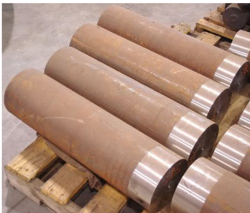
Obr. 17 Polotovar pro výrobu celobráběných klikových hřídelí [18]
