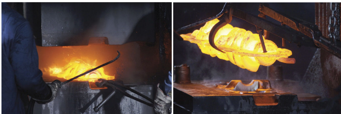
Obr. 16 Výsledný tvar výkovku s výronkem (vpravo) [18]
