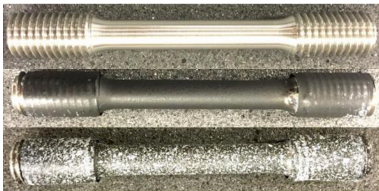
Obr. 3.19 Příprava zkušebních tyčí pro fotogrammetrickou metodu (měření deformace)
