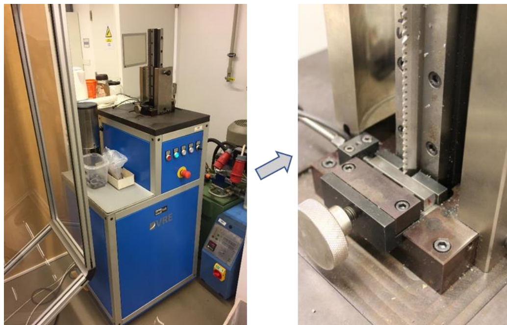
Obr. 3.22 Zařízení VRE pro vytvoření vrubu
