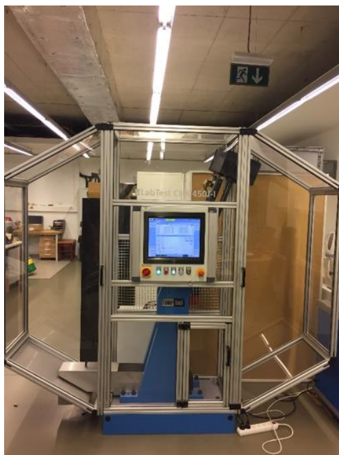
Obr. 3.21 Pracoviště pro zkoušku rázem v ohybu
