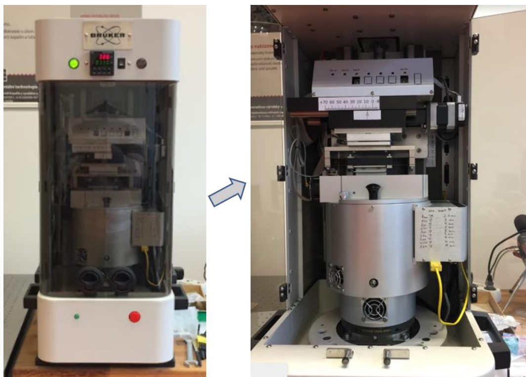
Obr. 3.25 Zařízení CETR UMI Multi Specimen Test System - Tribometr
