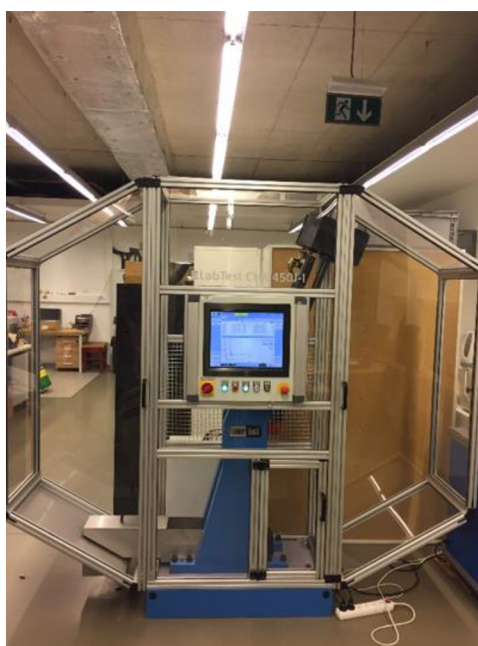
Obr. 3.21 Pracoviště pro zkoušku rázem v ohybu
