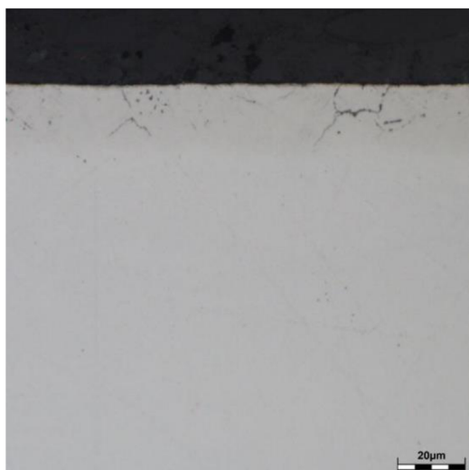
Obr. 3.12 Mikroskopické vyhodnocení vzorku nitridovaného Procesem 3 po aplikaci laseru s parametry danými procesem 7A
