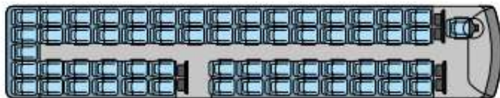
Uspořádání u verze 12,8 m: 59 míst + 1 28-59* míst s prostorem pro vozíčkáře nebo bez Obr. č. 18: Iveco Magelys Line rozložení interiéru [44]
