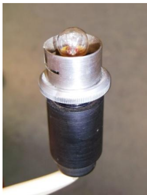
Obr. 21 Uložení žárovky v synoptoforu [D]
