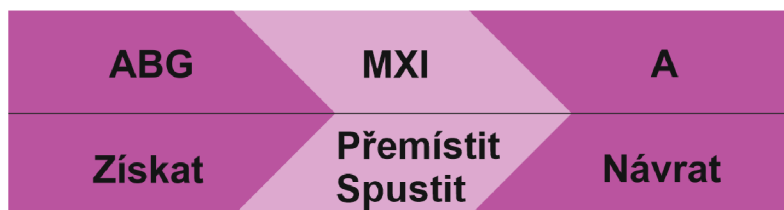
Obrázek č. 8: Sekvenční model – Řízené přemístění (Zdroj: Vlastní zpracování dle: Průmyslové inženýrství, © 2011)
