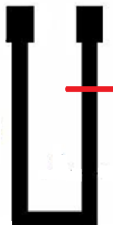
Obrázek 5. 25: Červená linie zobrazuje průchod jehly profilometru
