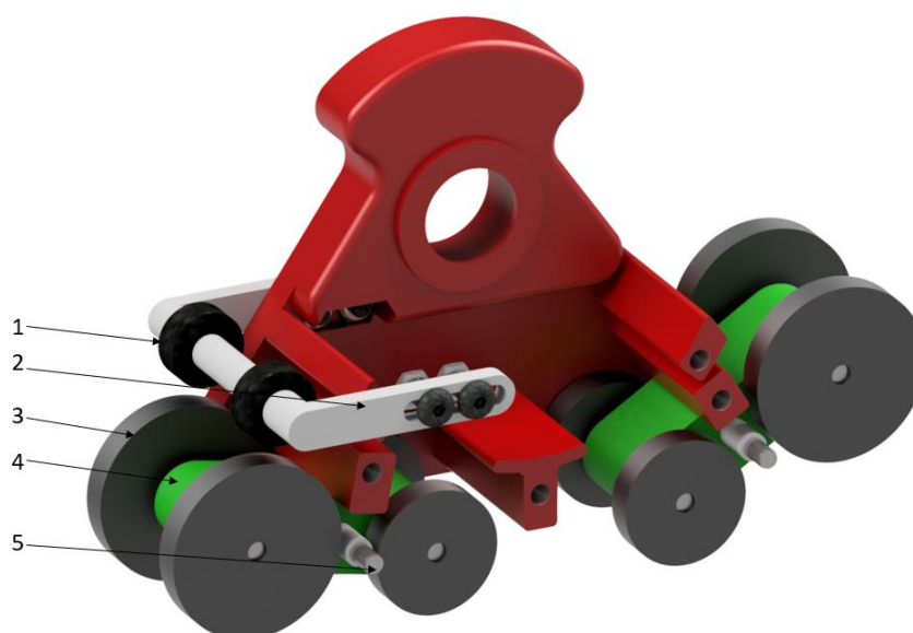
Obr. 20 Vedení a napínání pásu
