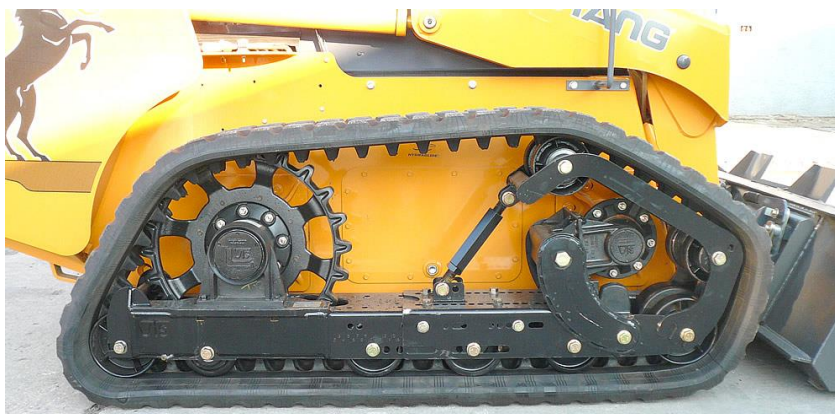
Obr. 12 Detail pásového podvozku Loegering VTS [26]
