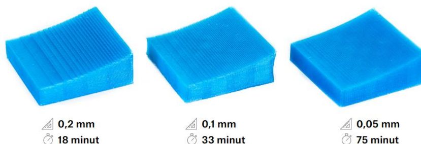
Obr. 9 Vliv výšky vrstvy na povrch výtisku a čas tisku [8]
