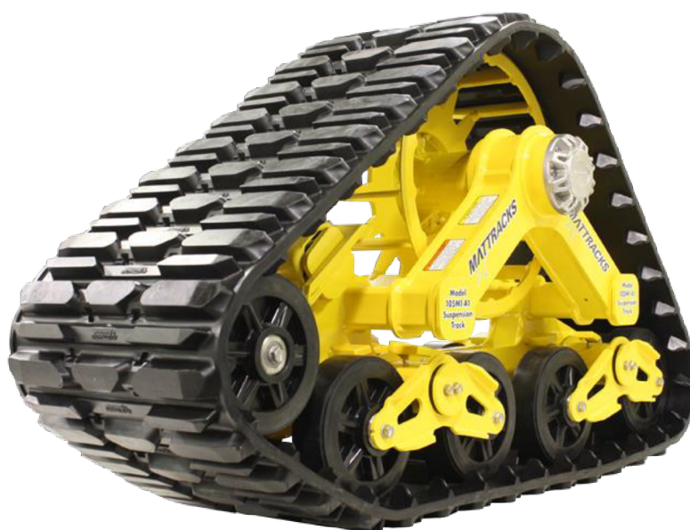
Obr. 13 Výměnná pásová jednotka od firmy Mattracks [27]
