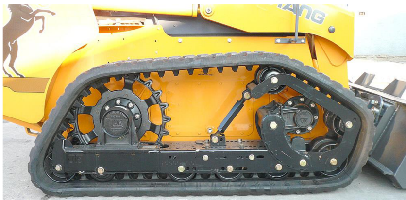
Obr. 12 Detail pásového podvozku Loegering VTS [26]
