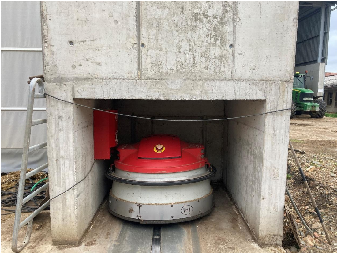
Obrázek 11 Automatický přihrnovač krmiva Lely Juno 150 (Autor, 2022)
