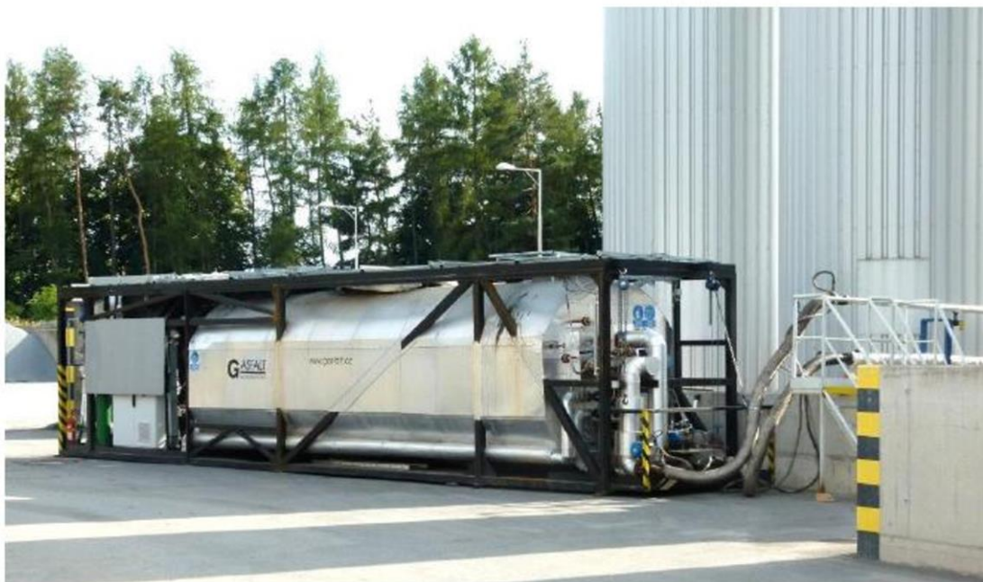
Obrázek 1: Mísící zařízení blender, ve kterém se vyrábí pojivo při mokřém procesu [4]
