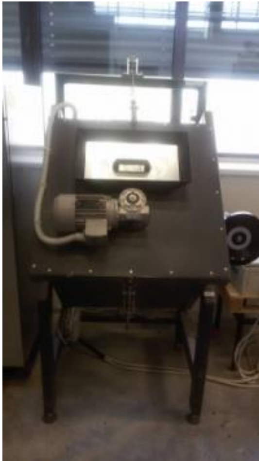
Obrázek 3: Laboratorní míchačka vhodná pro máchání kameniva s asfaltovým pojivem
