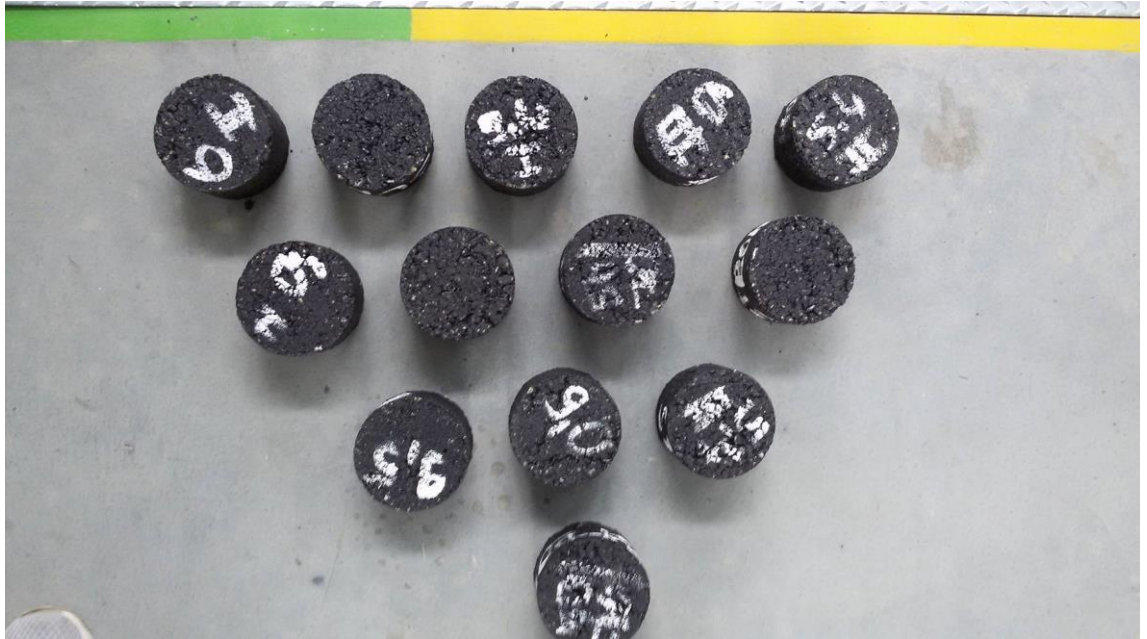
Obrázek 5: Marshallova tělesa vyrobená pomocí rázového zhutňovače
