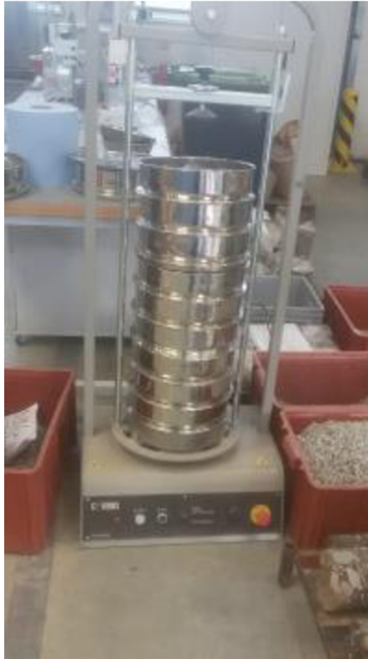
Obrázek 2: Zkušební síta s třesacím zařízením, vhodné pro síťový rozbor
