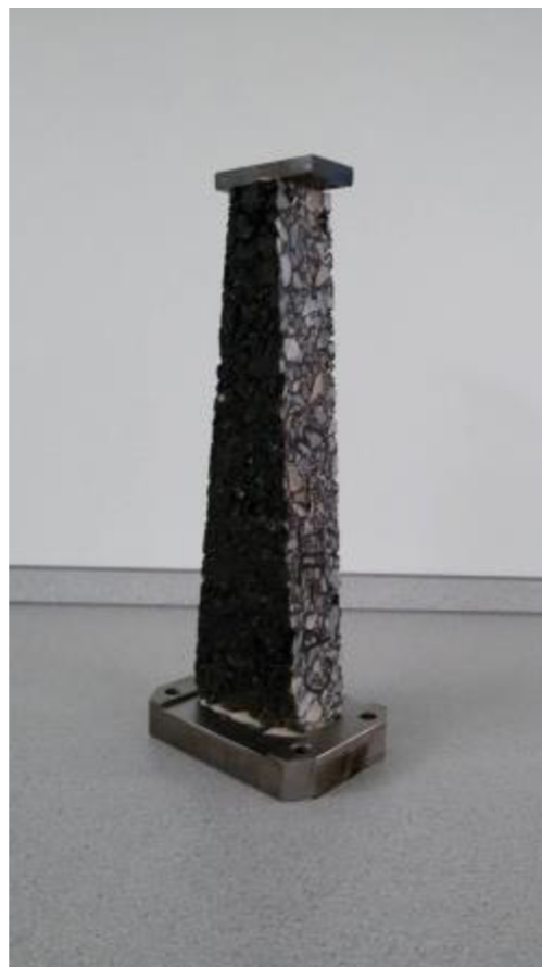
Obrázek 12: Přilepené zkušební těleso na horní a dolní kovovou destičku
