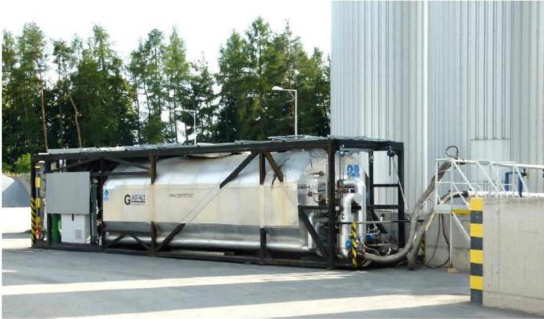
Obrázek 1: Mísící zařízení blender, ve kterém se vyrábí pojivo při mokřém procesu [4]
