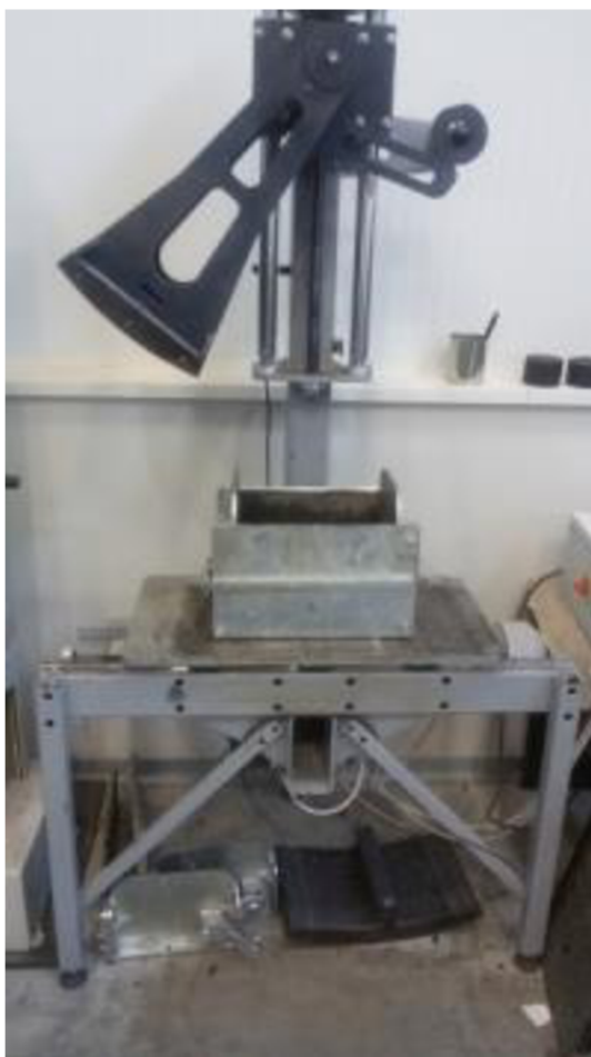
Obrázek 6: Segmentový hutnicí přístroj pro hutnění zkušebních desek
