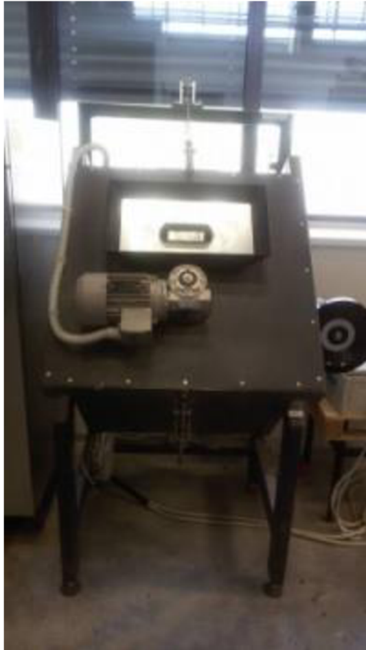
Obrázek 3: Laboratorní míchačka vhodná pro máchání kameniva s asfaltovým pojivem
