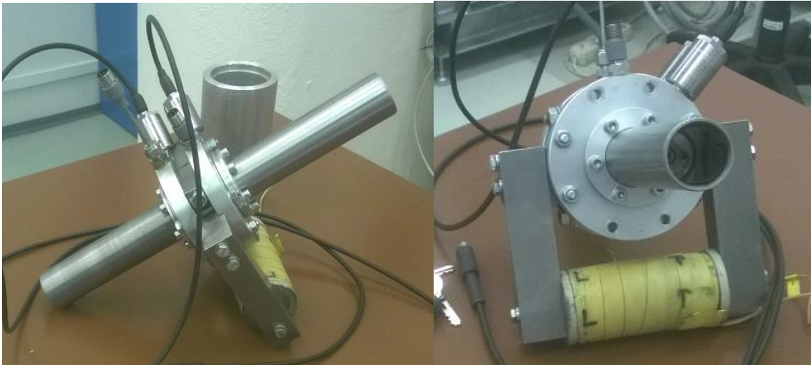
obr. 2-4 Magnetický obvod připevněny k tělu reometru
