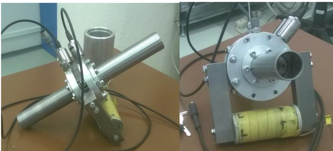
obr. 2-4 Magnetický obvod připevněný k tělu reometru
