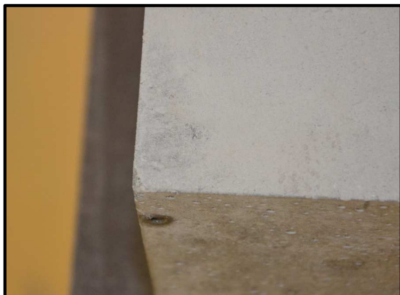
Obr. 20 Detail rohu krychle po obroušení
