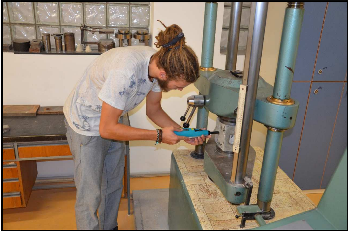
Obr. 18 Měření hodnoty vrácené energie pomocí tvrdoměru SilverSchmidt PC N
