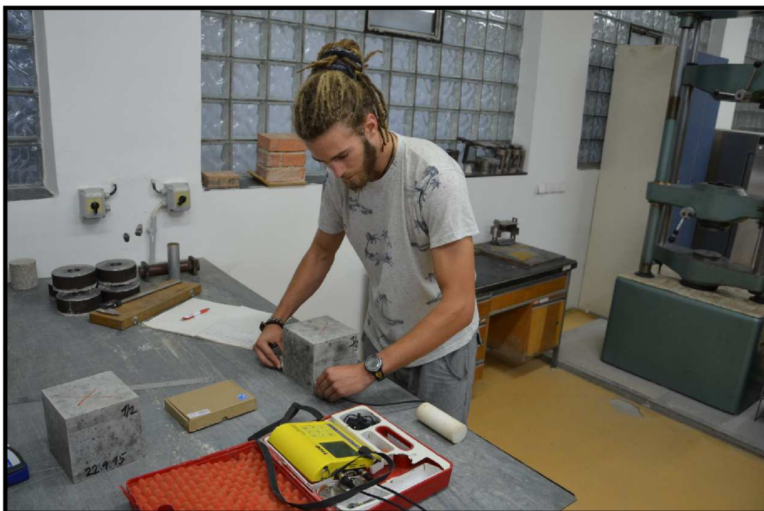
Obr. 15 Měření doby průchodu UZ impulsu
