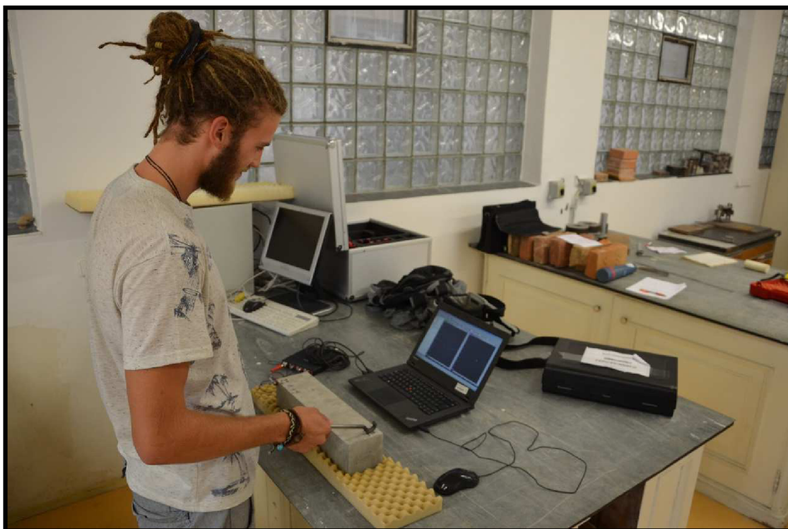
Obr. 16 Stanovení vlastní frekvence zkušebního hranolu
