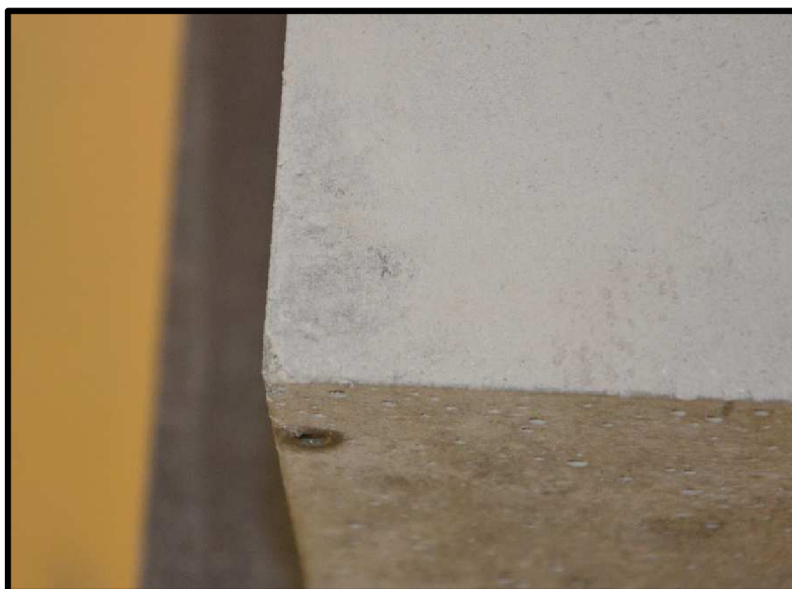
Obr. 20 Detail rohu krychle po obroušení
