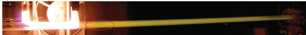
Obr. č. 4.16: Vliv množství příměsí \text{CH}_4 na jev pink afterglow
